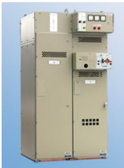
Нерегулируемые установки компенсации реактивной мощности типа КРМ-6(10) напряжением 6 кВ и 10 кВ, частотой 50 Гц, мощностью от 450 до 3150 кВАр предназначены для повышения значения коэффициента мощности ( $\cos \varphi$ ) в электрических распределительных трёхфазных сетях промышленных предприятий и других объектов.
